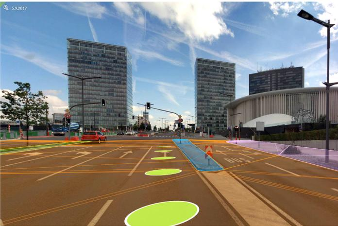
Die RFK von Cyclomedia basiert auf Street Ortho, also Orthobildern, die nicht wie üblicherweise von oben durch Befliegung oder Satelliten erfasst, sondern aus den 360°-Panoramabildern abgeleitet werden. Der große Vorteil von Street Ortho ist, dass die meisten bewegten Objekte aus den Aufnahmen herausgerechnet werden können und so freie Sicht auf die Oberfläche bieten. Die RFK kann zur Gewinnung von Grundlagendaten dienen.
